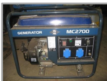
Groupe électrogène (2,4Kw, moteur essence de 15L, 43kg autonomie en fonctionnement continu 11 heures)
